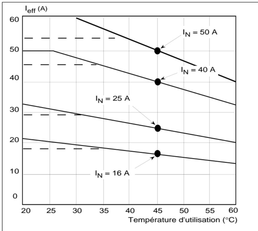
Courbes de courant admissible en fonction de la température ambiante ( $I_N$  = courant nominal à 45°C).
